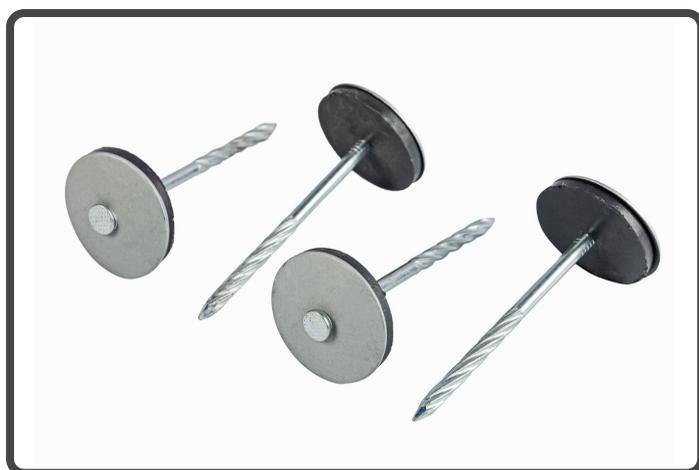
Os Pregos Telheiro Trelitelas são fabricados com aço de baixo teor de carbono (BTC) galvanizado, com o corpo ardox, borracha flexível e arruela metálica. São comercializados em sacos com 50 pacotes contendo 30 unidades de prego em cada.
